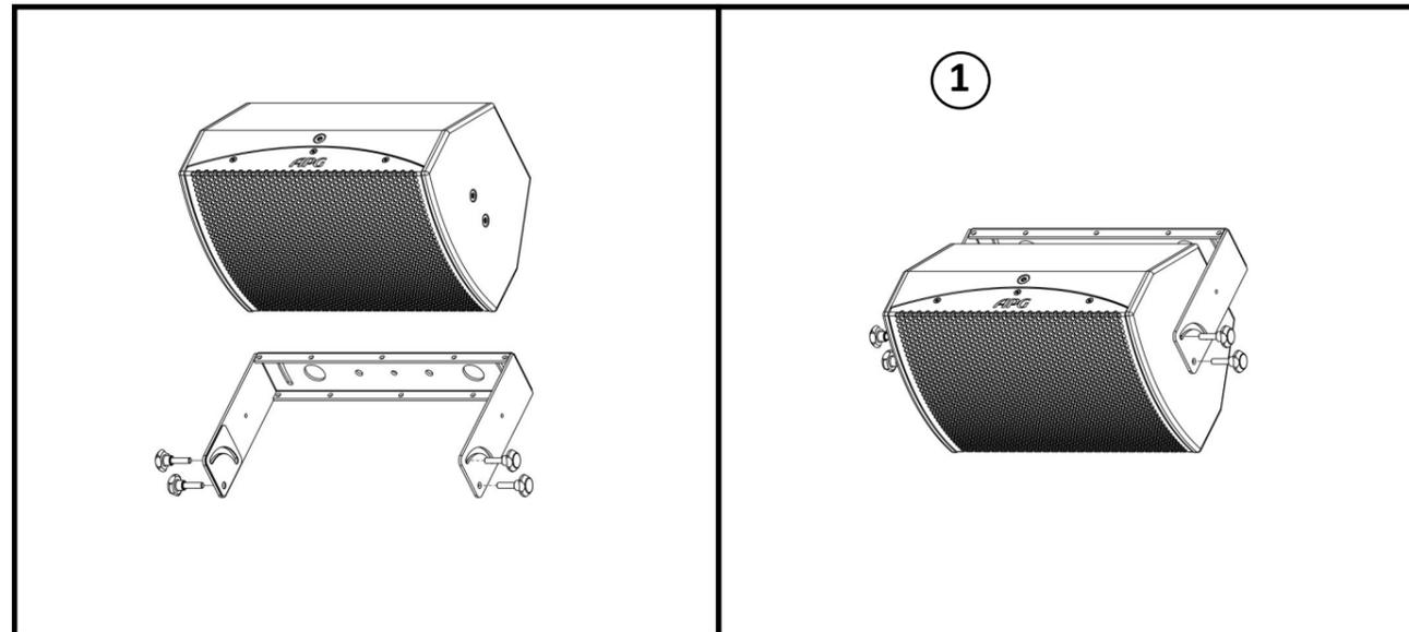
Etrier de fixation pour iX8 à la verticale / iX8 vertical mounting bracket (iX8BV)
