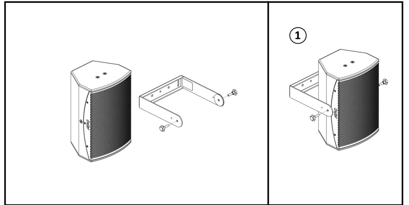
Fixation adaptateur K&M / K&M adaptor (Ref : K&M 24281)
