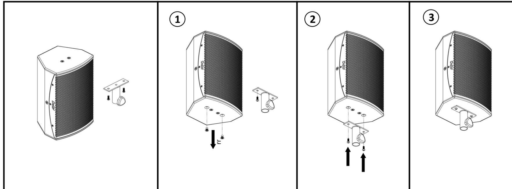
Pièce d'angulation murale pour iX8 / iX8 wall angulation bracket (iX8BVAP)
